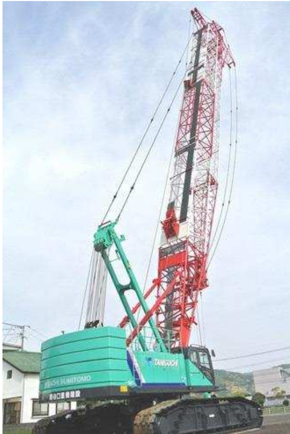
クローラークレーン
