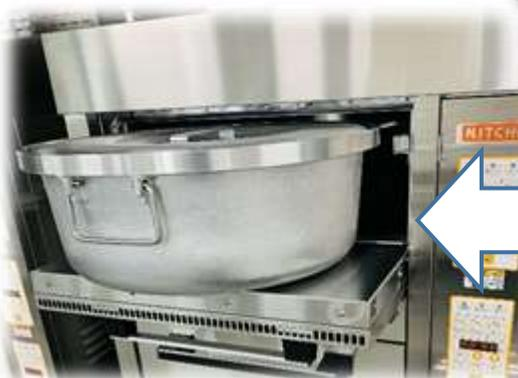
これは**炊飯器**です。ガス式で、点火した後は、自動で消火します。1つの釜に約6kgの米が入り、約30分くらいで炊けます。
