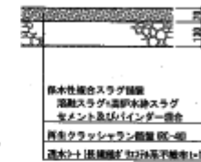
透水性スラグ舗装
