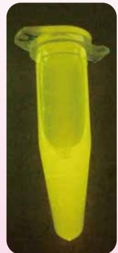
ルシフェリン、ルシフェラーゼ、ATPをミニ試験管内で反応させたヒカリ
