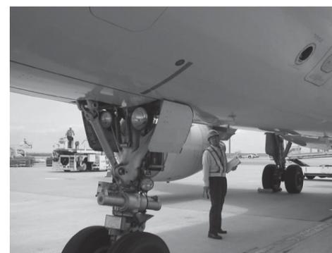
機体の胴体・主翼(エンジン含む)・脚などに部品欠落・着氷等がないか点検
