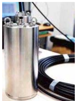
電源を必要としないFBG方式の光水位計
