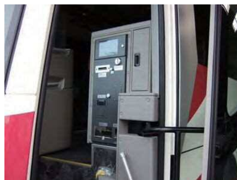
バリアフリー型高速バス料金機 (しずてつジャストライン様車両設置機)
