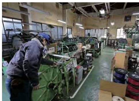
燃合機と呼ばれる装置で、被覆されたコードのほか、パイプ、光ファイバ、銅線などをロープ状に撚り合わせています。
