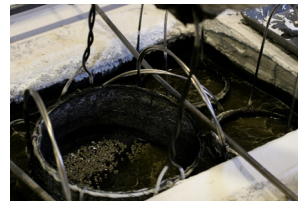
本社工場・塩浴軟室化炉
