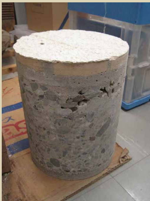
耐震性を確認するため、壁の一部がくり抜かれた。すると、白い塗料層の下から、薄茶色のタイルの層が現れた。
