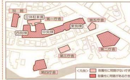
【図1】各庁舎配置と耐震状況
